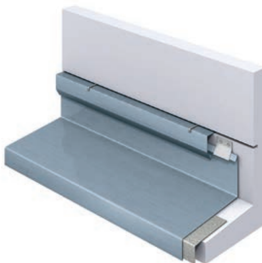
Skizze 26: Putzleiste in Mauerfuge eingelassen
