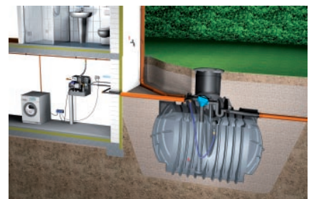
Kompletanlage zur Regenwassernutzung, Erdtank, Hauswasserwerk, Verrohrung/Anschluss, für die Speisung von Waschmaschinen und WC-Spülung (Fa. Nautilus Wassermanagement)
